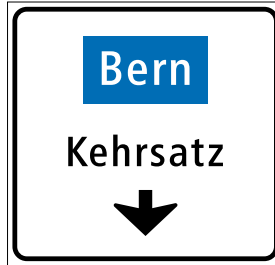
4.42 Einspurtafel über Fahrstreifen auf Nebenstrassen (Art. 53)
